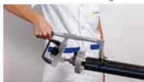
Utilizzare gli appositi raschiatori. Pulire le superfici con apposito detergente.
