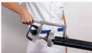
Et utiliser les gratteurs spéciaux. Nettoyez les surfaces avec un détergent approprié. Marquer la profondeur d'insertion.
