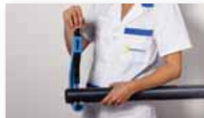
Coupez le tuyau avec le coupe-tube.
