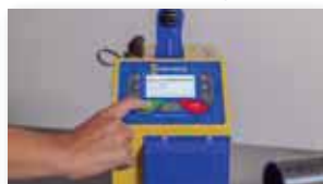
Leer el código de barras e iniciar la soldadura. Realizar los controles necesarios (alineación, profundidad de inserción e indicadores de fusión).
