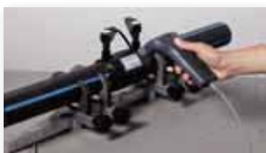
Lisez le code à barres et commencer la soudure. Effectuer les contrôles nécessaires (alignement, profondeur d'insertion et indicateurs de fusion).
