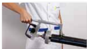
Usar los rascadores idóneos. Limpiar las superficies con el detergente idóneo.
