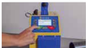
Leggere il codice a barre ed avviare la saldatura. Effettuare i controlli previsti (allineamento, profondità d'inserimento e indicatori di fusione).
