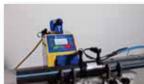
Leer el código de barras e iniciar la soldadura. Realizar los controles necesarios (alineación, profundidad de inserción e indicadores de fusión).
