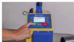
Lisez le code à barres et commencer la soudure. Effectuer les contrôles nécessaires (alignement, profondeur d'insertion et indicateurs de fusion).
