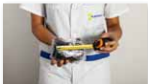
Controllare le dimensioni degli elementi da saldare.
