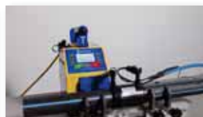
Lisez le code à barres et commencer la soudure. Effectuer les contrôles nécessaires (alignement, profondeur d'insertion et indicateurs de fusion).
