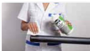
Utilizzare gli appositi raschiatori. Pulire le superfici con apposito detergente.
