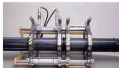
Phase 5 soudure avec les éléments en pression
