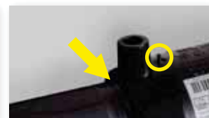
Leggere il codice a barre ed avviare la saldatura. Effettuare i controlli previsti (allineamento, profondità d'inserimento e indicatori di fusione).
