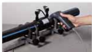
Leer el código de barras e iniciar la soldadura. Realizar los controles necesarios (alineación, profundidad de inserción e indicadores de fusión).
